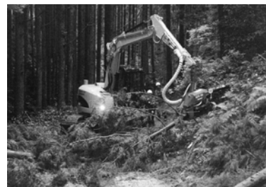
間伐作業状況 (ハーベスタで枝払い・造材作業中)
