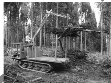
間伐後の林地残材搬出作業 (フォワーダで幹末梢など積み込み中)
